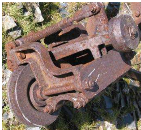
Vue latérale du système de fixation de la benne sur le câble.
